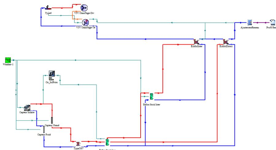
Figure 6 : Modélisation de la centrale solaire sous TRNSYS
