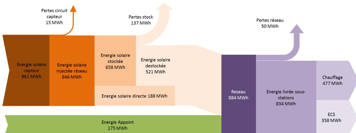
Figure 9 : Diagramme des flux d'énergie annuels du réseau de chaleur solaire de l'îlot A
