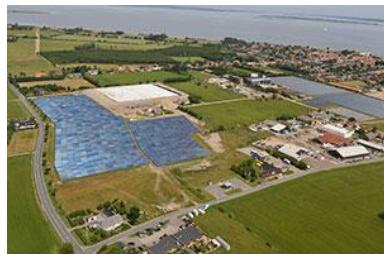
U Marstalu, na otoku Ærø, 33 400 m<sup>2</sup> solarnih kolektora u kombinaciji sa 75 000 m<sup>3</sup> spremnika osigurava 55%
