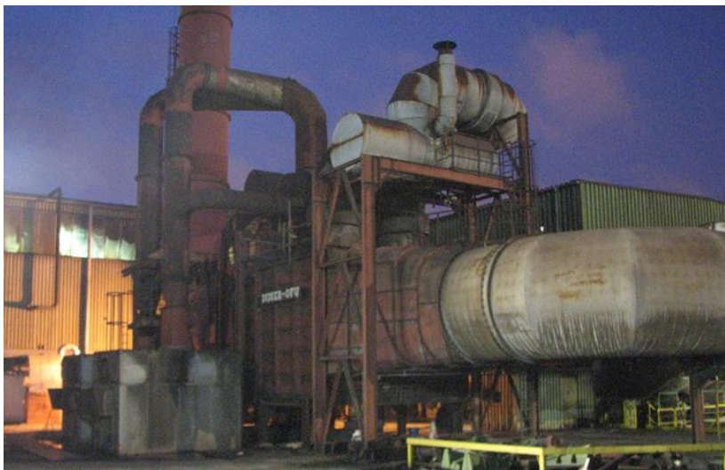
Abbildung 36: Mögliche Abwärmenutzung am Hubherdofen 104
