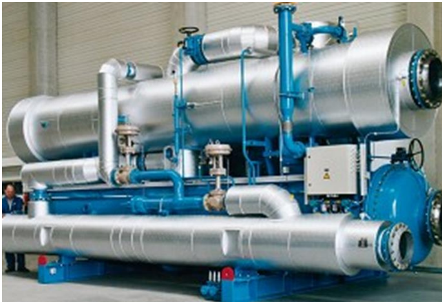
Abbildung 40: Seewasser Wärmepumpe Värtan-Stockholm 112
