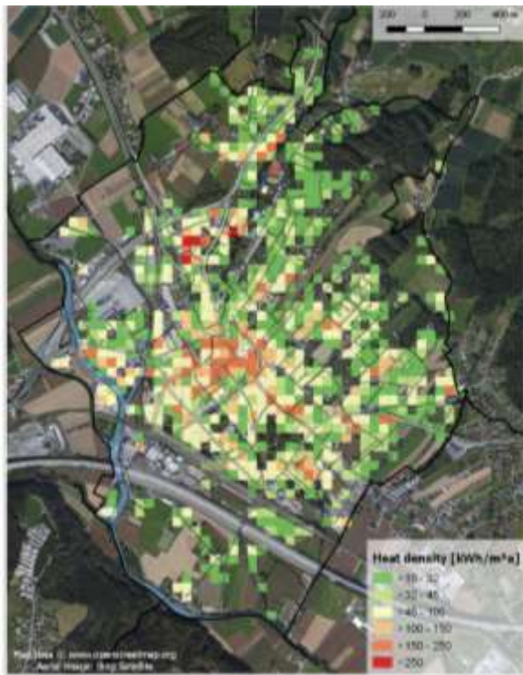
Abbildung 16: Wärmedichte - Status Quo (Quelle: AEE INTEC)
