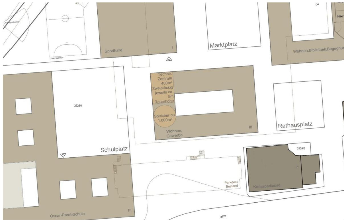
Abbildung 30: Planausschnitt Energiezentrale und Langzeit-Wärmespeicher
